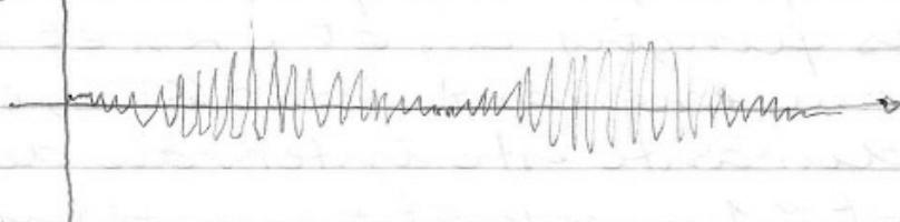
Note a semelhança destes gráficos com o fenômeno do batimento. Estes são o resultado da superposições de 2 ondas sonoras, por exemplo - com frequências quase iguais. Por causa desta pequena diferença de frequências, as 2 ondas têm diferença de fase que se move regularmente de  $0$  a  $2\pi$ , em cada local. Isto significa que a interferência resultante é alternadamente construtiva e destrutiva, e um gráfico do final resultante se parece com o qualquer dos gráficos acima.
